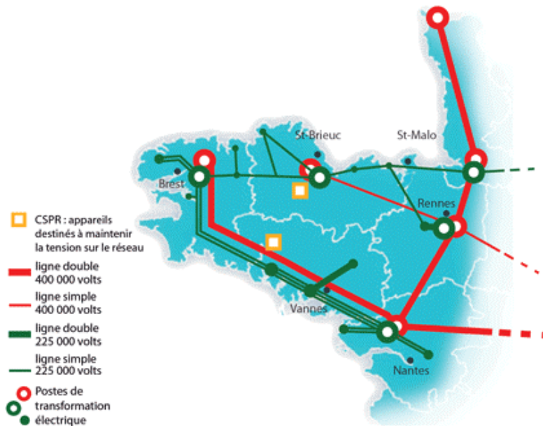
Figure 12: Carte du réseau de transport d'électricité en Bretagne (source: http://www.ouest-ecowatt.com/ )
